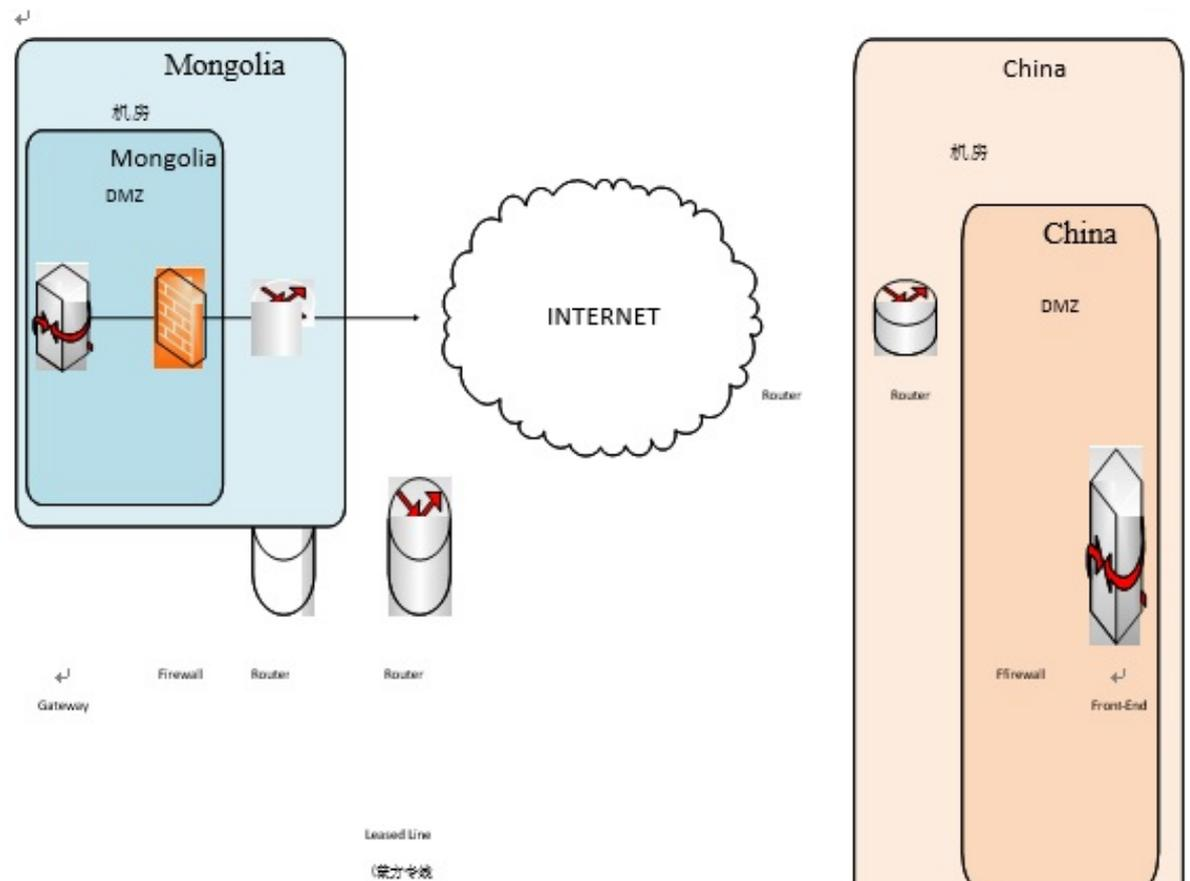
ВПН сеть установлена между монгольской зоной DMZ и шлюзом безопасности китайской DMZ. Шлюз безопасности открывает и удостоверяет безопасный сетевой канал, зашифрованный протоколом IPSec, для обеспечения информационной безопасности.
