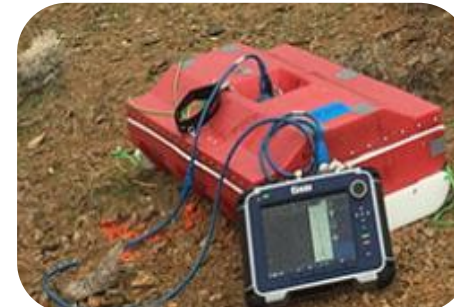
Ground penetrating Radar Data Acquisition SIR-4000 Авто замын үеийн зузаан тодорхойлох / газрын гүний хэмжилт хийдэг /
