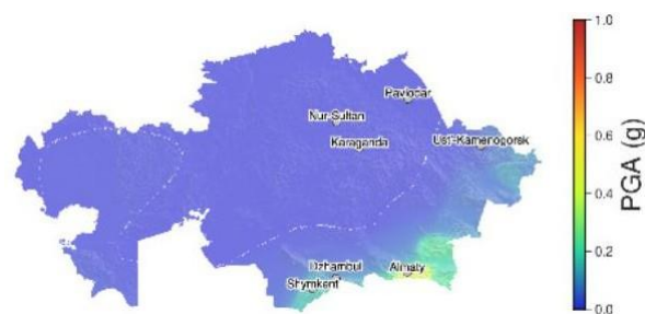
Рисунок 18: Карта сейсмической опасности для пикового ускорения грунта (PGA) с 10%-ной вероятностью превышения расчетного сейсмического воздействия в ближайшие 50 лет
