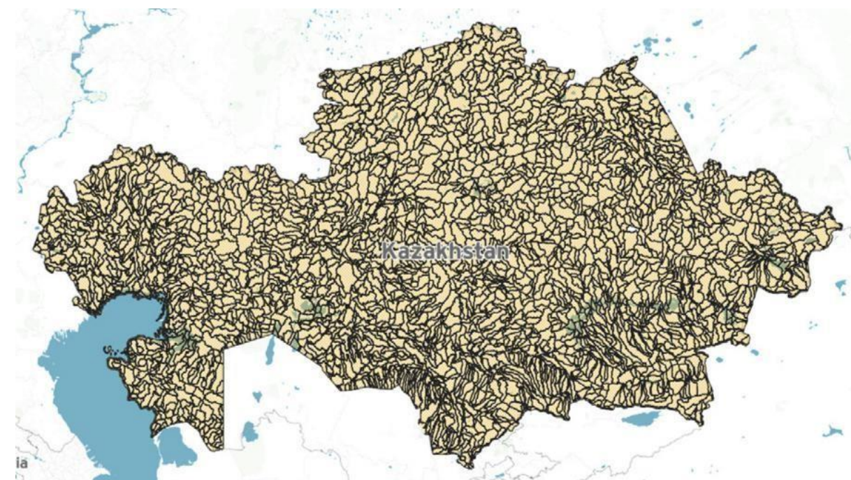
Рисунок 20: Гидрологические водосборы, используемые для моделирования паводков
