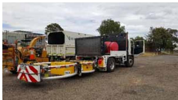
Мобильные демпфирующие устройства, установленные на грузовом автомобиле, обеспечивают физическую защиту для рабочих на участках дорожных работ, где установка защитных барьеров или закрытие дороги невозможны.
