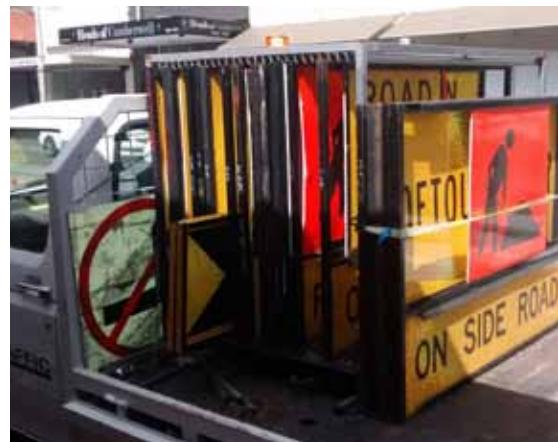
Можно изготовить простые кассеты для перевозки комбинированных знаков на участок работ и обратно в небольшом грузовике или фургоне.
