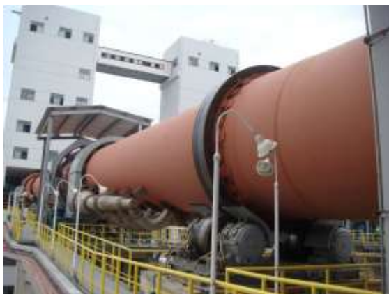
Цементообжигательная печь: 1450 °C
